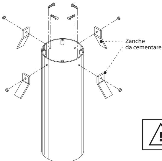
Fissare mediante i bulloni in dotazione le zanche alla cassaforma
