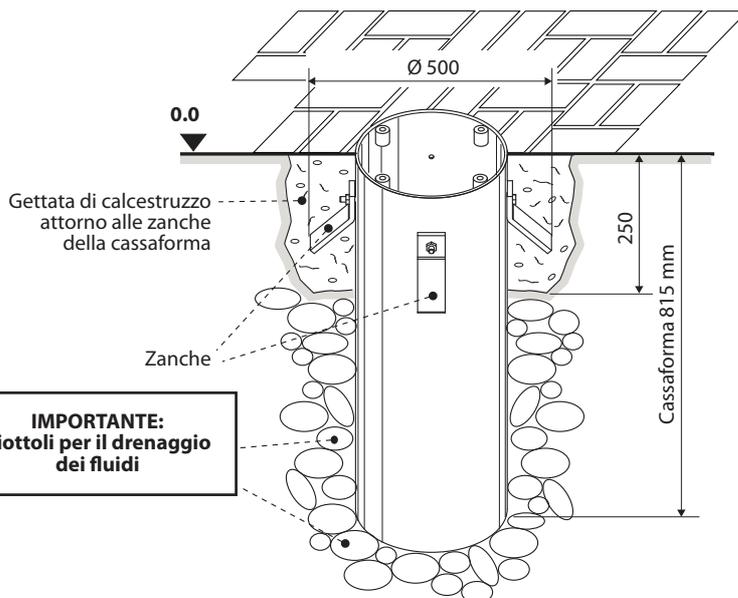
Installazione a filo pavimento della cassaforma di contenimento del Gaspo 252
