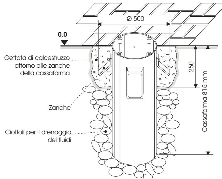
Installazione a filo pavimento della Cassaforma
