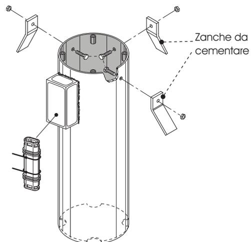
Fissare mediante i bulloni in dotazione
