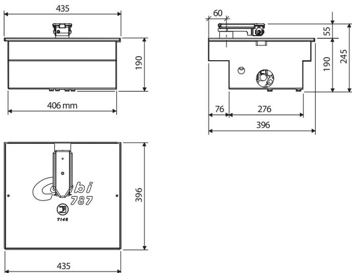
**COMBI 787** è un apricancello oleodinamico interrato ed è formato da un automatismo - motore elettrico/pompa - accoppiato ad un martinetto idraulico a doppio effetto, che permette la rotazione fino a 110° di un'anta da aprire. Il blocco motore-pompa-martinetto è equipaggiato di un dispositivo di sicurezza antischiacciamento, garantito dalle valvole di massima pressione, incorporate nel circuito oleodinamico e adeguatamente protette per evitare manomissioni nel tempo dopo l'installazione.
