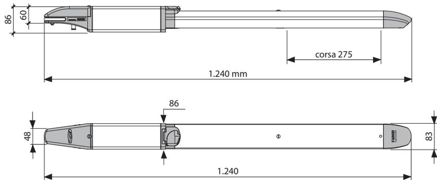
**NUPI 66** è un attuatore oleodinamico per l'apertura e la chiusura automatica di cancelli a battente, progettato e costruito con strumenti e impianti industriali FADINI di massima precisione.
